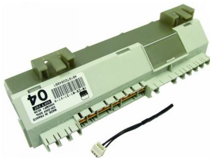
Scheda di controllo LVS MT2IG40 utilizzata sui modelli serie Dolphin
