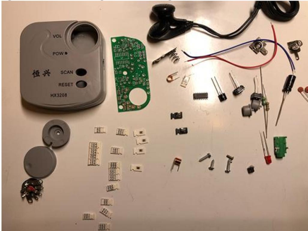
Iniziate il montaggio partendo da quelli piu' piccoli (condensatori e resistenze) e proseguite con i componenti SMD; quindi quelli a foratura e quelli di maggiore ingombro.
